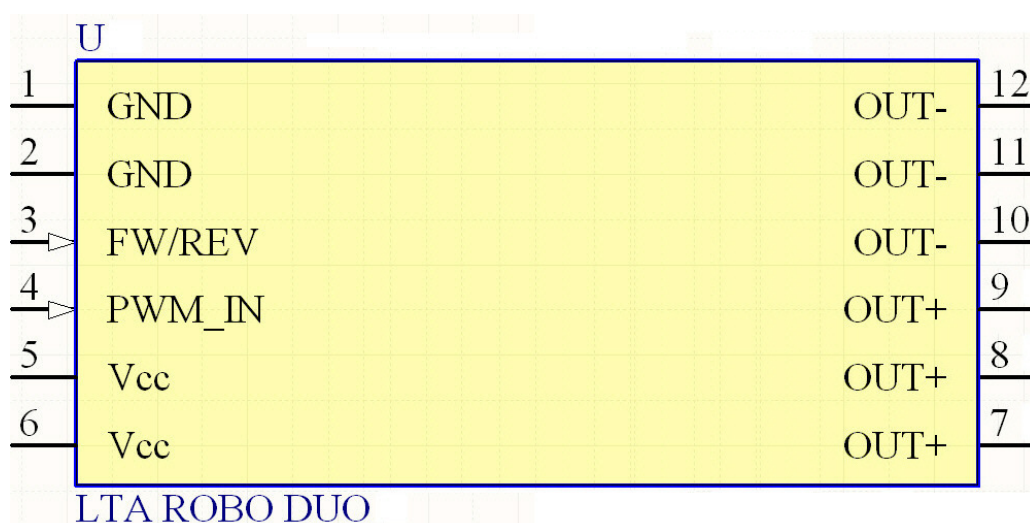
Rysunek 1 Wyprowadzenia modułu LTA ROBO DUO
